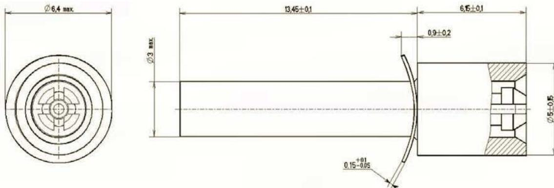
**FAST-LOCKING SCREW LOCK ASSEMBLY FOR HYBRID SAVER CONNECTORS (VARIANT 05)**
