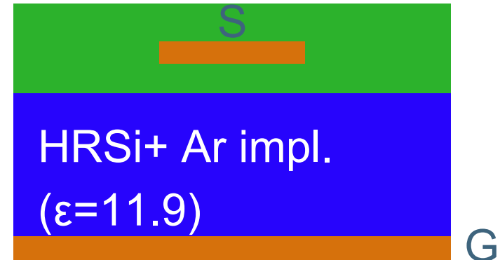
HRSi Microstrip ( w=85\mu\text{m} )
