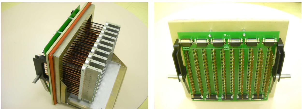
Fig. 4. Custom climatic chamber door
